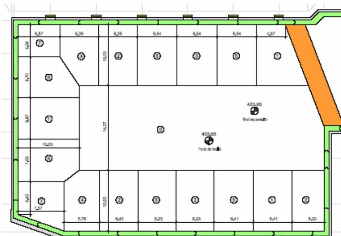
Figure 15. Extrait du plan de terrassement, étapes de réalisation du sous-radier (DCG SA)
